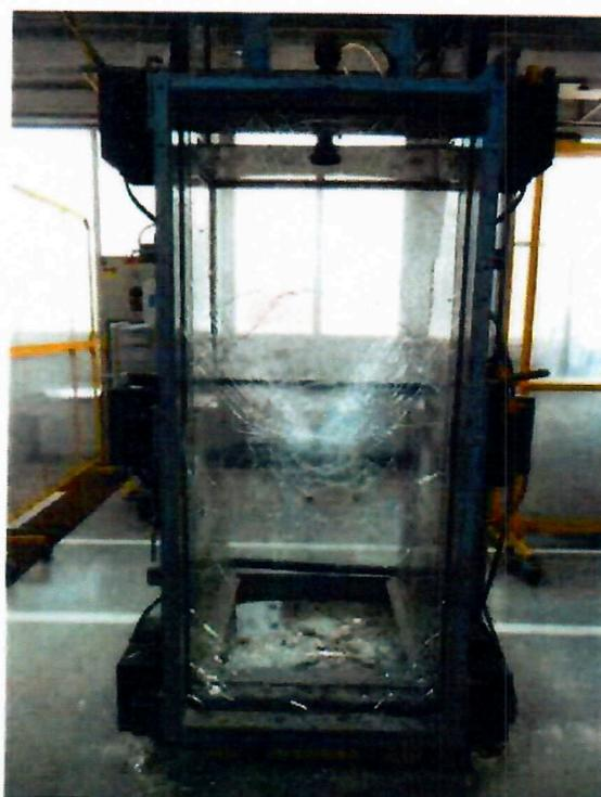
**Vitrage N°4, hauteur de chute 450 mm**
