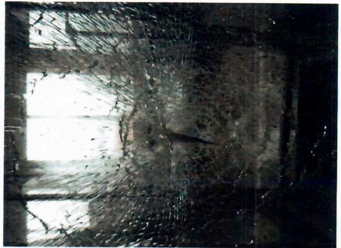
**Vitrage N°4, hauteur de chute 450 mm**
