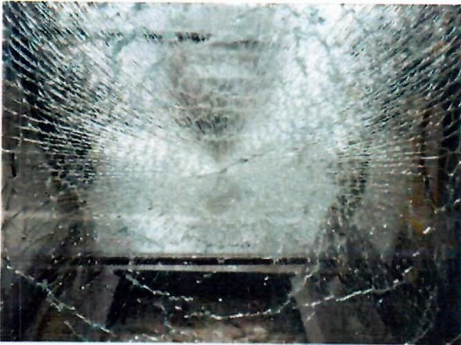
**Vitrage N°3, hauteur de chute 450 mm**
