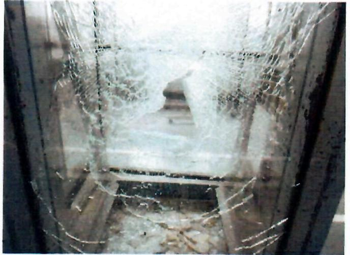
**Vitrage N°2, hauteur de chute 1200 mm**
