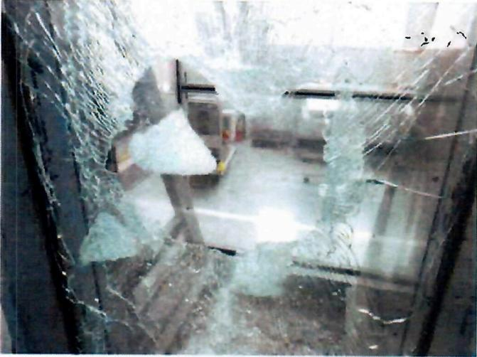
**Vitrage N°1, hauteur de chute 1200 mm**
