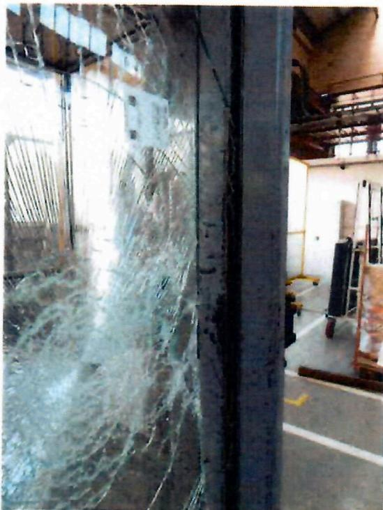
**Vitrage N°1, hauteur de chute 1200 mm**
