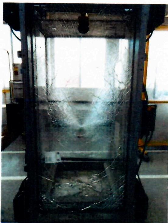
**Vitrage N°3, hauteur de chute 450 mm**
