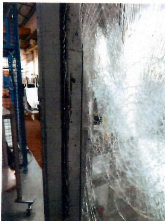
**Vitrage N°2, hauteur de chute 1200 mm**
