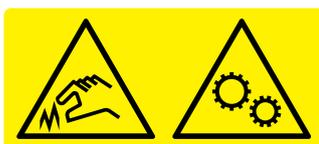
Los plotters de corte S One utilizan cuchillas afiladas. Tocar la cuchilla con las manos desnudas puede causar lesiones.
