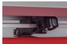
Cambiar la presión del rodillo de empuje central (CE6000-120 PLUS)
